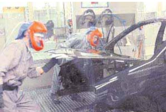
Los trabajadores de las cabinas de lacado se limitan ahora a supervisar que los robots hayan hecho una correcta aplicación de la pintura.
