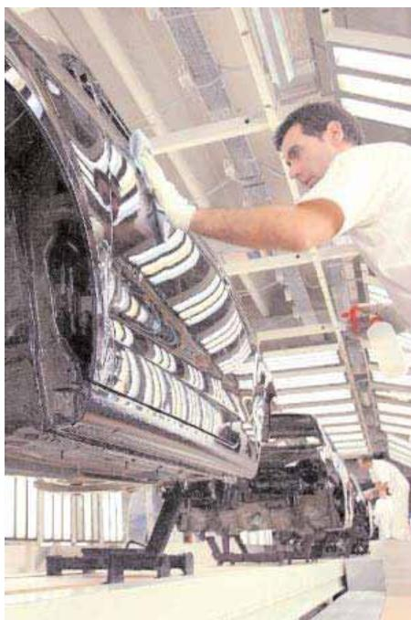
Las carrocerías se revisan, pulen y limpian antes de salir hacia montaje.
