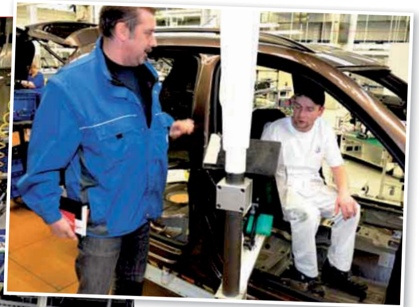
Ergonomischer Montagesitz: Der Betriebsrat hat mit dem Unternehmen die Einbau vereinbart.
